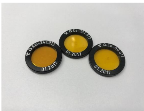
Рисунок 1 – Общий вид источников ОСГИ-РТ
