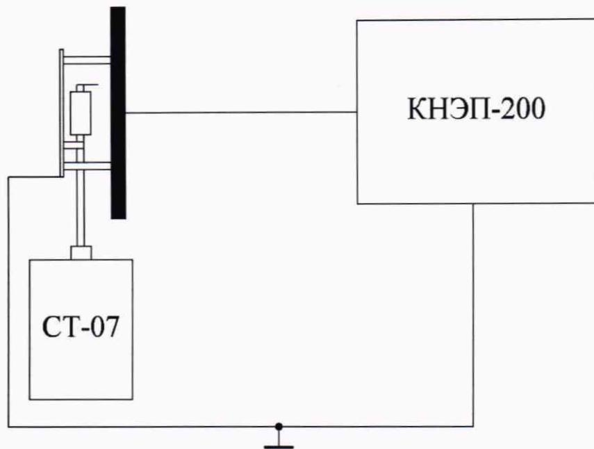
Рисунок 4 - Соединение эталона с измерителем при проведении измерений поверхностной плотности электрических зарядов
