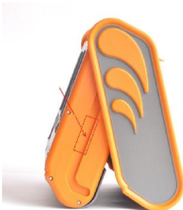
Рисунок 3 – Место пломбирования MPI-530.
