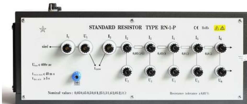
Рисунок 1 – Фотография общего вида мер сопротивления петли короткого замыкания прецизионных многозначных RN-1-P
