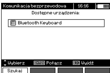
В списке доступных устройств выберите одну из клавиатур и нажмите "ENTER – Подключить" – измеритель отображает индикатор хода процесса, отсчитывая 30 секунд. За это время необходимо ввести на клавиатуре PIN-код измерителя и подтвердить клавишей ENTER, также расположенной на клавиатуре.
