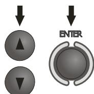
Используя клавиши **▲** и **▼**, установите необходимые параметры и подтвердите нажатием клавиши **ENTER**. При установке параметров защиты клавишами **◀** и **▶** выберите параметр, а клавишами **▲** и **▼** установите его значение.
