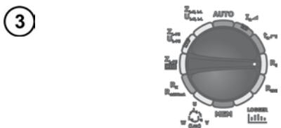
Установите поворотный переключатель режимов работы в положение **R<sub>E</sub>**
