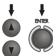
Клавишами **▲** и **▼** установите требуемое значение измерительного напряжения и подтвердите выбор нажатием клавиши **ENTER**.
