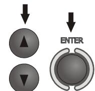
Используя клавиши  $\blacktriangleup$ ,  $\blacktriangledown$  выберите параметр, для отображения на дисплее: полное сопротивление  $Z_s$  или ожидаемый ток короткого замыкания  $I_k$ ; подтвердите выбор нажатием **ENTER**.
