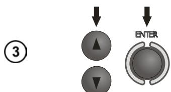
Клавишами **▲** и **▼** установите требуемое значение измерительного напряжения и подтвердите выбор нажатием клавиши **ENTER**.
