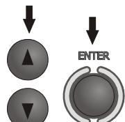
Используя клавиши ▲, ▼ выберите автоматическое увеличение номера ячейки после записи в память или вручную (авто инкрементация выключена) и подтвердите выбор нажатием клавиши **ENTER**.
