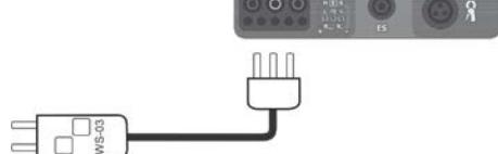
Подключите кабель WS-03 или WS-04 с сетевой вилкой UNI-Schuko.
