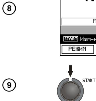
Нажмите клавишу **START** для начала следующего измерения без отключения измерительных проводников от объекта.
