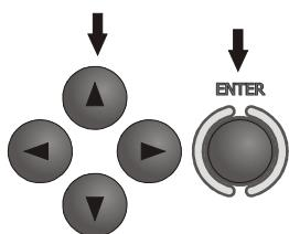
Используя клавиши  $\blacktriangleleft$ ,  $\triangleright$  и  $\blacktriangleup$ ,  $\blacktriangledown$  выберите номинальное напряжение и частоту сети. Нажатием клавиши **ENTER** для подтверждения выбранного пункта.
