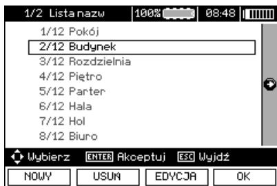
Нажмите клавишу **F1** **СОЗДАТЬ** для того, чтобы добавить очередное название в список (до 99 позиций), а клавишу **F2** **УДАЛИТЬ**, чтобы удалить его элемент.
