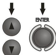
Клавишами **▲** и **▼** установите измерение удельного сопротивления и подтвердите выбор нажатием клавиши **ENTER**.
