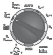
Установите поворотный переключатель режимов работы в положение  $Z_{L-PE}/U_{L-PE}$ .
