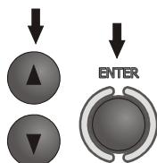
Используя клавиши  $\blacktriangleup$ ,  $\blacktriangledown$  выберите время до автоматического выключения подсветки, подтвердите выбор нажатием клавиши ENTER.
