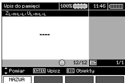
Свободная ячейка для данного типа измерения.
