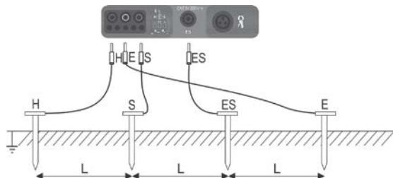
Измерительные зонды устанавливаются однолинейно на одинаковом расстоянии  $L$  и подключаются к прибору согласно рисунку.
