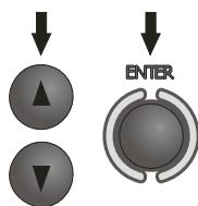
Используя клавиши  $\blacktriangle$  и  $\blacktriangledown$ , установите необходимые параметры и подтвердите нажатием клавиши **ENTER**. При установке параметров защиты клавишами  $\blacktriangleleft$  и  $\blacktriangleright$  выберите параметр, а клавишами  $\blacktriangle$  и  $\blacktriangledown$  установите его значение.
