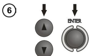
Клавишами **▲** и **▼** установите требуемое значение измерительного напряжения и подтвердите выбор нажатием клавиши **ENTER**.
