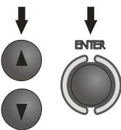
Клавишами  $\blacktriangle$  и  $\blacktriangledown$  установите требуемое значение измерительного напряжения и подтвердите выбор нажатием клавиши **ENTER**.
