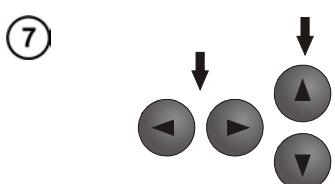
Используя клавиши **◀**, **▶** перейдите к выбору количества отсчетов, клавишами **▲**, **▼** установите количество отсчетов – время регистрации рассчитывается на основе периода дискретизации и количества отсчетов. Нажмите клавишу **F4 OK** для подтверждения и переходу к следующим параметрам.
