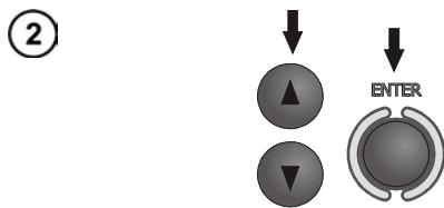
Используя клавиши **▲**, **▼** выберите включение или выключение беспроводного соединения, подтвердите выбор нажатием клавиши **ENTER**.
