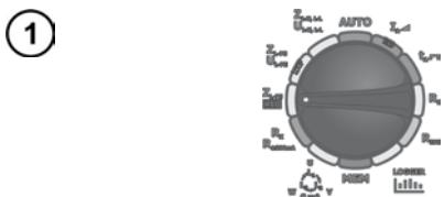
Установите поворотный переключатель режимов работы в положение **Z<sub>I-PE</sub> RCD**.
