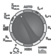
Установите поворотный переключатель в режим  $Z_{L-N}$ ,  $UL-N$ ,  $L-N$ .
