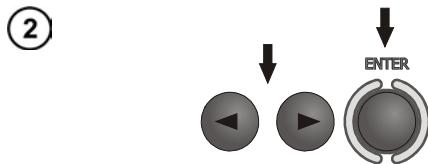
Используя клавиши **◀▶** включите или выключите звуковой сигнал при нажатии на клавиши.
