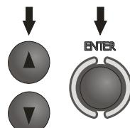
Клавишами **▲** и **▼** установите требуемое значение измерительного напряжения и подтвердите выбор нажатием клавиши **ENTER**.
