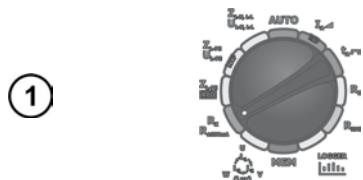
Установите поворотный переключатель режимов работы в положение **R<sub>x</sub> R<sub>±200mA</sub>**.
