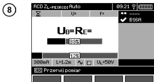
Процесс измерения иллюстрируют индикаторы хода выполнения:
