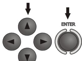
Используя клавиши **◀, ▶** и **▲, ▼** выберите нужную размерность расстояния и результата, нажатием клавиши **ENTER** выберете нужный пункт.
