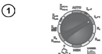
Установите поворотный переключатель режимов работы в положение  $t_{\Delta n}$ .
