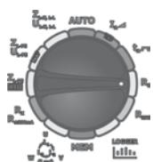
Установите поворотный переключатель режимов работы в положение **R<sub>E</sub>**
