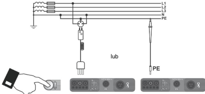
Подключите измеритель согласно схеме представленной на рисунке, приложите палец к электроду прикосновения на 1 секунду. Если на PE проводнике будет обнаружено напряжение, на дисплее отобразится сообщение **PE!** (ошибка подключения, провод PE подключен к фазному проводу). Данное сообщение будет сопровождаться продолжительным звуковым сигналом. Данная функция активна во всех режимах, связанных с измерением параметров УЗО и петли короткого замыкания.
