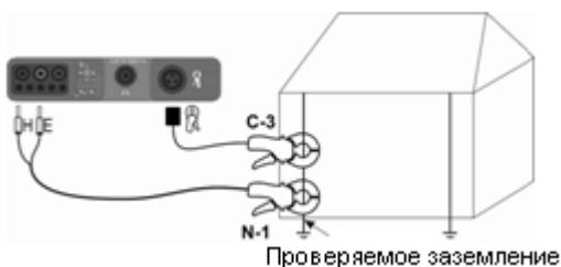
Подключите передающие клещи к разъемам Н и Е, при этом измерительные клещи должны быть подключены к стандартному разъему.
