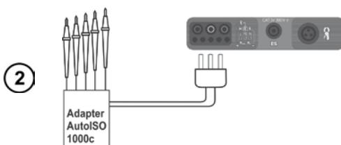
Подключите адаптер AutoISO-1000c. Измеритель MPI-530 автоматически определит подключение адаптера и отобразит символ на дисплее.
