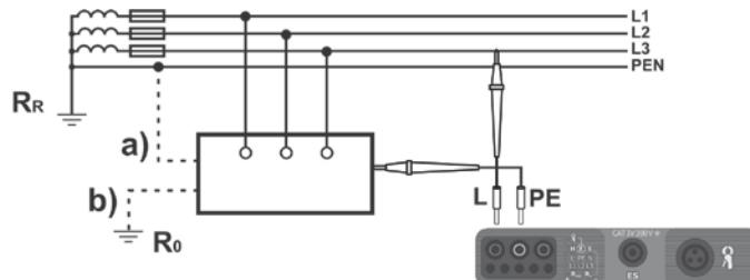
Проверка эффективности защиты от поражения током через корпус устройства в случае:
