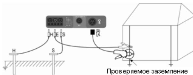
Установите токовый зонд и подключите его к разъему **H** измерителя.
