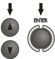
Клавишами▲ и▼ установите требуемое расстояние между зондами и нажмите клавишу **ENTER**, чтобы начать измерение.
