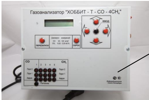
Рисунок 4 – Общий вид блока индикации стационарных газоанализаторов, схема пломбировки от несанкционированного доступа, место нанесения знака поверки
