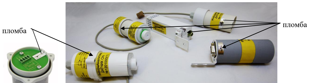
Рисунок 2 – Общий вид блоков датчиков стационарных газоанализаторов, схема пломбировки от несанкционированного доступа
