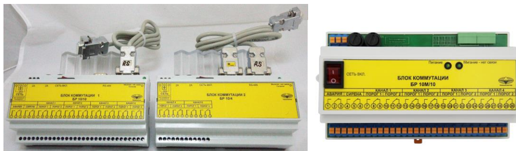
Рисунок 6 – Общий вид блоков коммутации
