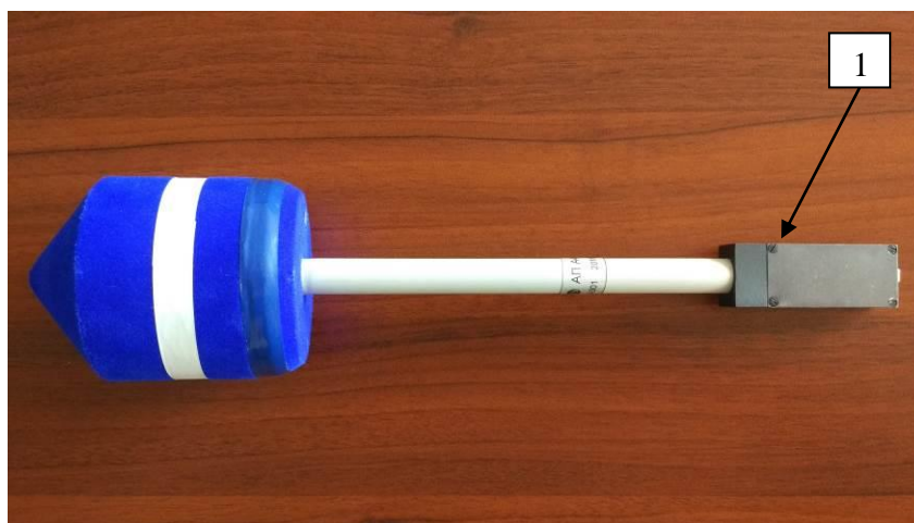
Рисунок 2 – Схема пломбирования от несанкционированного доступа БОИ
