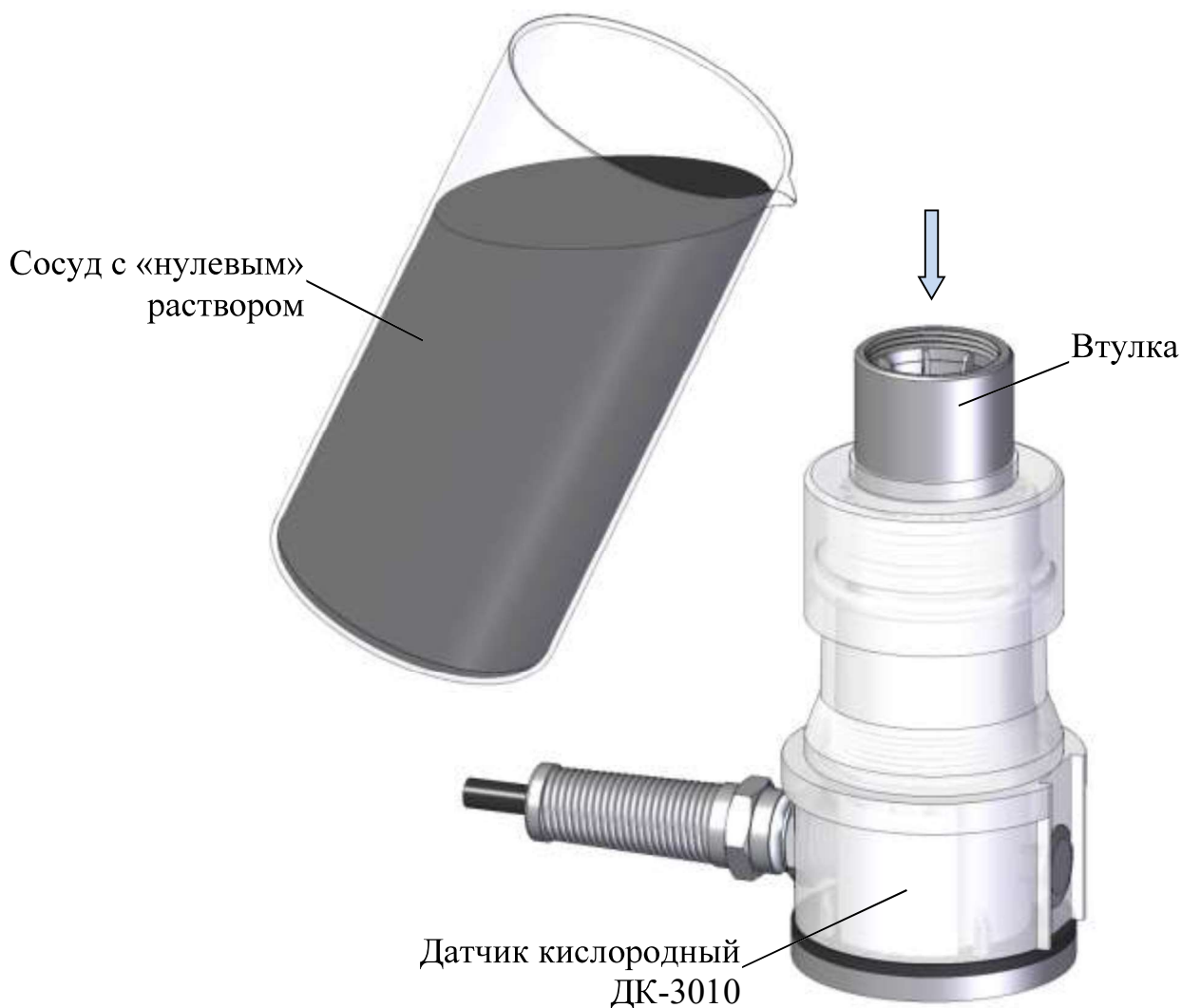
Рисунок 2.2 – Проверка показаний в «нулевом» растворе
