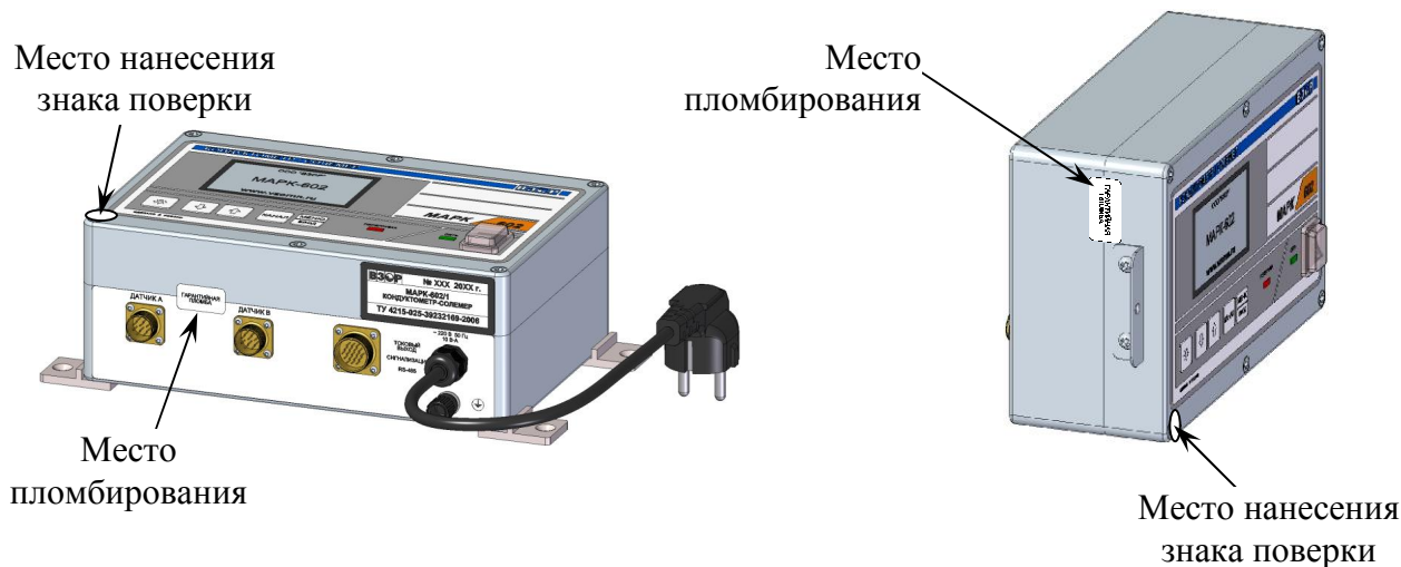
б - Схема пломбирования от несанкционированного доступа
