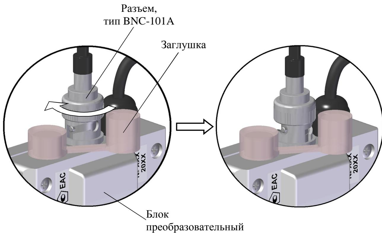
Рисунок 2.3 – Подсоединение комбинированного электрода
