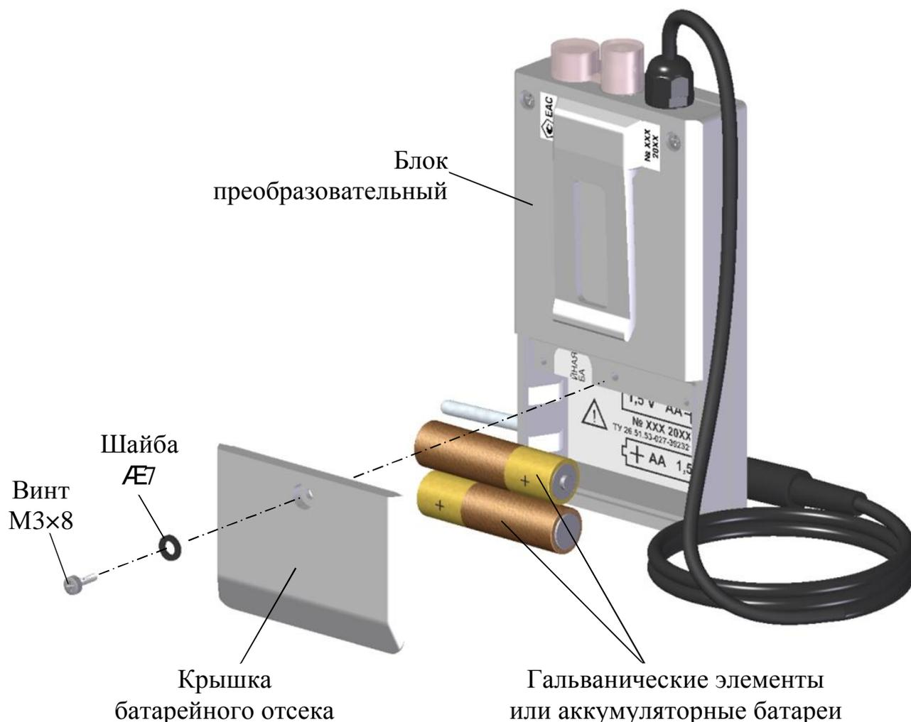
*Рисунок 2.1 – Установка гальванических элементов или аккумуляторных батарей*
