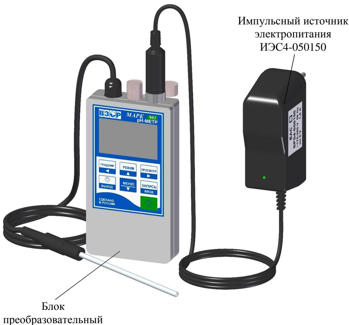
*Рисунок 3.1 – Зарядка аккумуляторных батарей*
