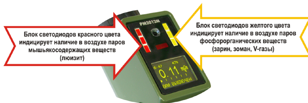
Рисунок 10.3 – Индикация о наличии паров токсичных веществ
