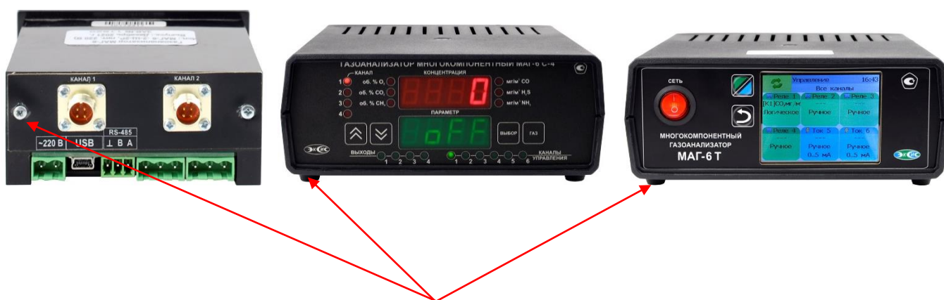
Рисунок 2б - Схема пломбирования от несанкционированного доступа (места пломбирования отмечены стрелками)
