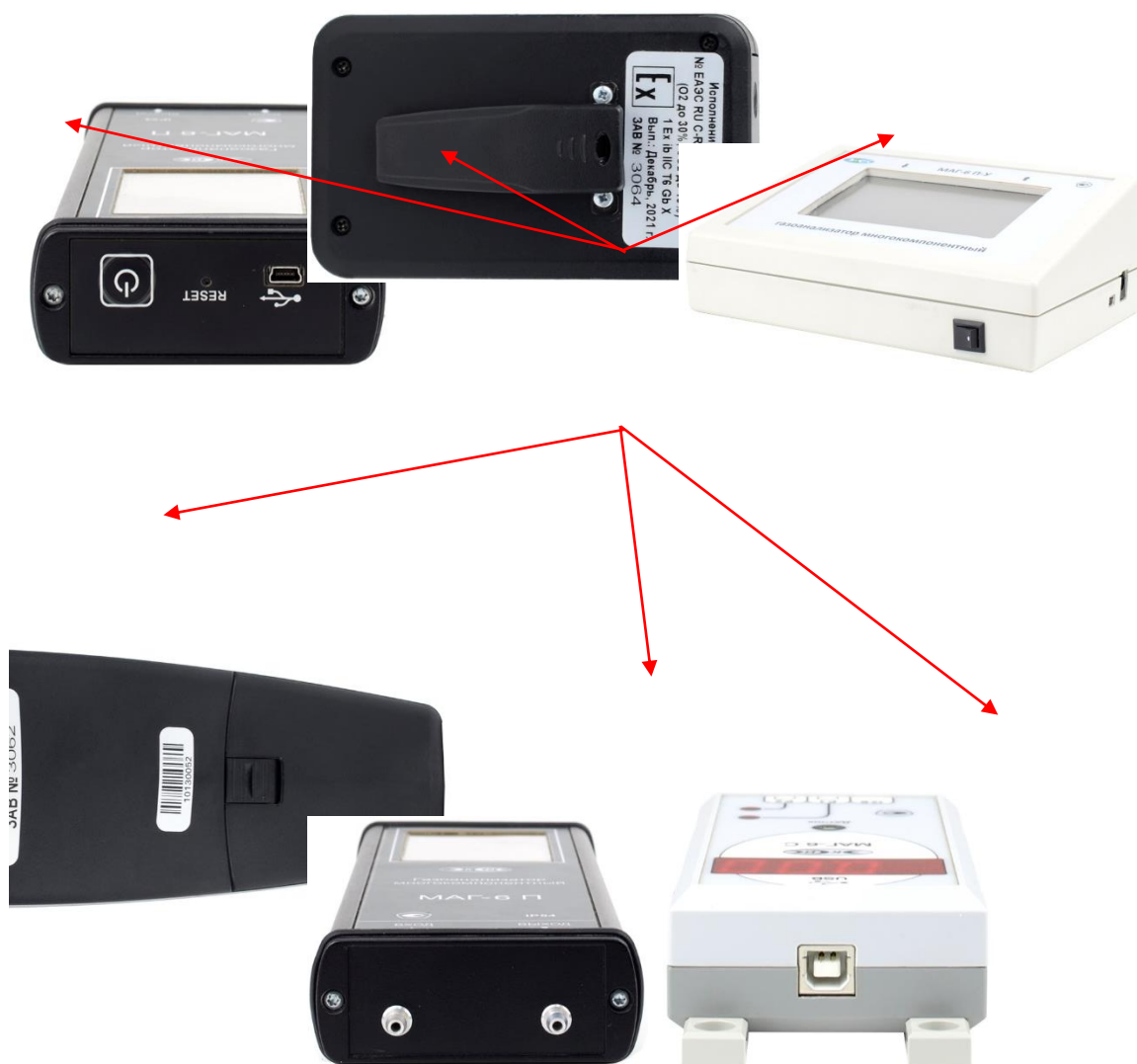
Рисунок 2а - Схема пломбирования от несанкционированного доступа (места пломбирования отмечены стрелками)
