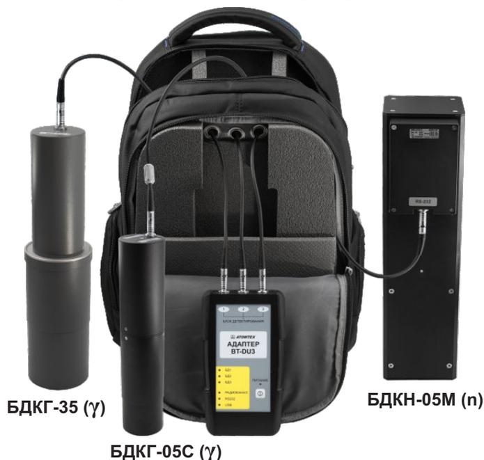
Спектрометр предназначен для скрытного обнаружения источников радиоактивного излучения и является эффективным техническим средством предупреждения радиологических террористических угроз или других действий, таких как незаконное хранение, использование, передача и транспортировка радиоактивных материалов.
