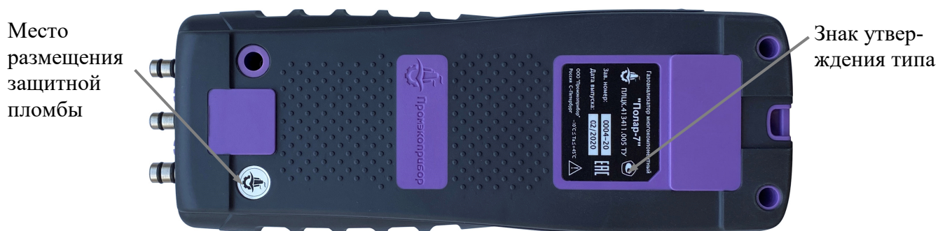
Рисунок 2 – Схема пломбировки газоанализаторов от несанкционированного доступа и место нанесения знака утверждения типа
