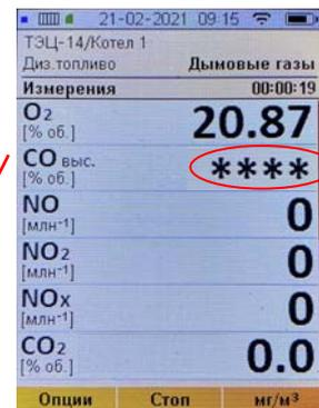
7) При обнаружении по результатам корректировки нулевых показаний неисправности датчика **O<sub>2</sub>** и/или того, что недостаточно продут датчик **СО** (для исполнений газоанализаторов, имеющих два измерительных канала **СО** – датчик **СО<sub>выс</sub>**), по каналам **СО<sub>2</sub>** (расчетный), **alfa**, **Q<sub>a</sub>** и **КПД**, также как и по каналу неисправного (непродутого) датчика, выводится код ошибки данных – «\*\*\*\*»:
