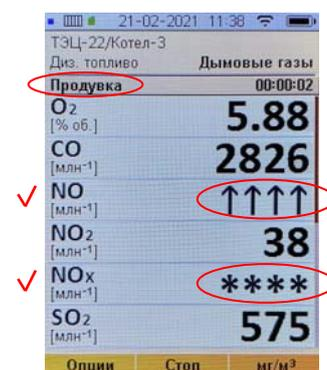
Продувка прибора будет продолжаться до тех пор, пока выходной сигнал перегруженного датчика не придет в норму, но не менее 30 секунд. Во время продувки все операции с результатами измерений (сохранение, печать и т.д.) будут недоступны.
