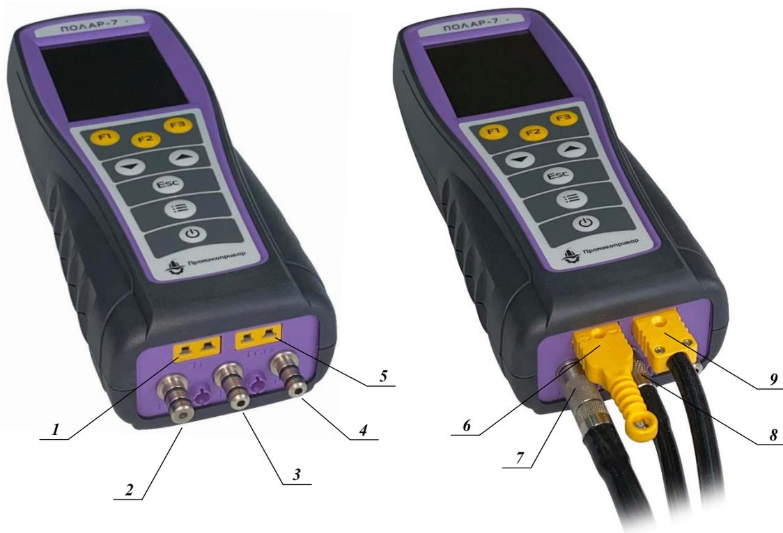
Рисунок 21 – Подсоединение к прибору пробоотборного шланга и внешнего датчика температуры воздуха
