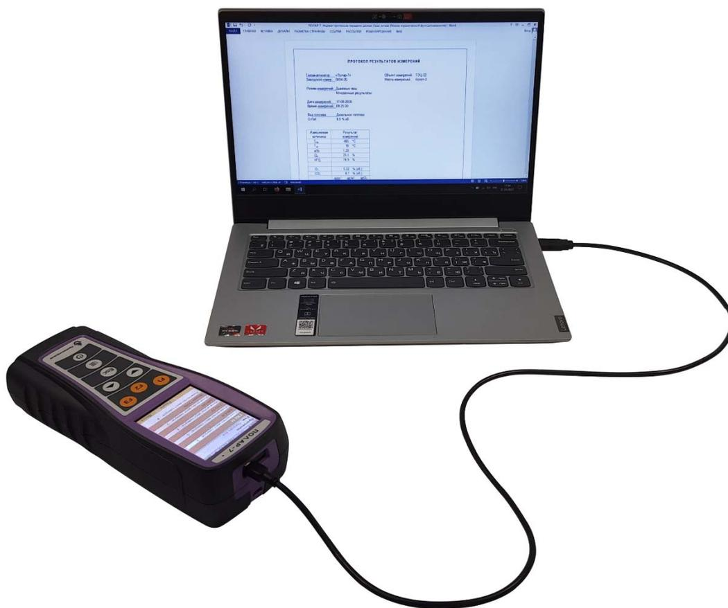
Рисунок 39 – Подключение газоанализатора к персональному компьютеру
