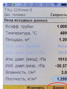
4. После завершения ввода всех параметров нажмите кнопку **[Далее]** – на дисплее появится сообщение о необходимости подготовки к калибровке нуля встроенного в прибор датчика давления, использующегося для измерений разности давлений газов (динамического давления потока):
