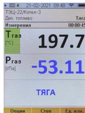
3. Отрицательные показания газоанализатора будут соответствовать разрежению газового потока («**тяге**») газового потока в газоходе, положительные – избыточному давлению («**напор**»):
