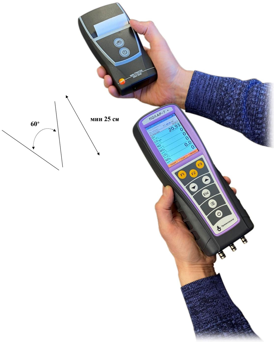
Рисунок 25 – Расположение внешнего ИК-термопринтера и газоанализатора при печати результатов измерений
