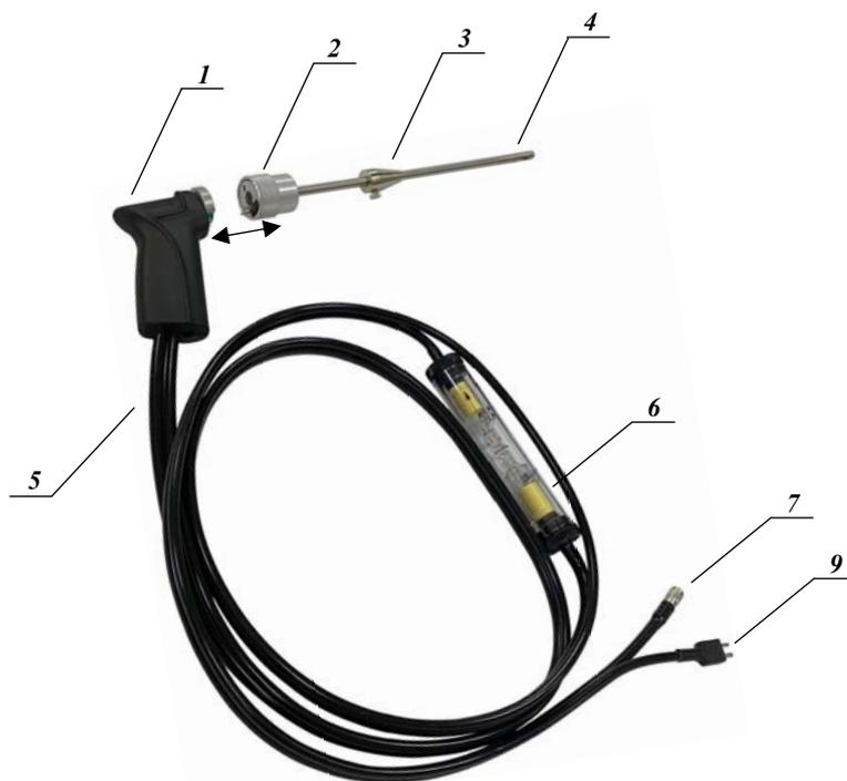
Рисунок 6 – Пробоотборный зонд и пробоотборный шланг типа А
