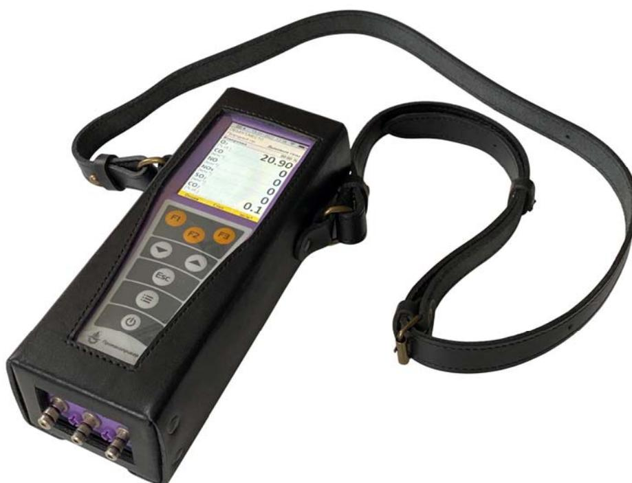
Рисунок 19 – Газоанализатор «Полар-7» в футляре для переноски
