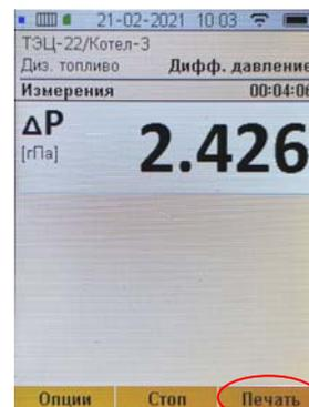
**ВНИМАНИЕ!** В процессе передачи данных на принтер, принтер необходимо удерживать в заданном положении (см. п. 10.6.7, шаг 2). После завершения передачи данных принтер, вне зависимости от своего положения, автоматически завершит печать.
