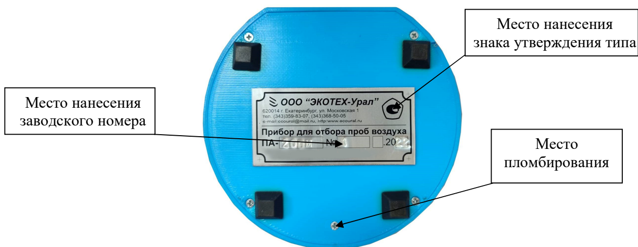
Рисунок 2 – Место нанесения заводского номера и знака утверждения типа, схема пломбирования
