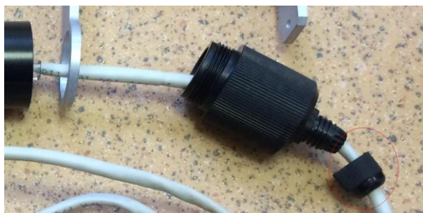
Рис.3ж. Ослабленный кабельный зажим гермоввода
