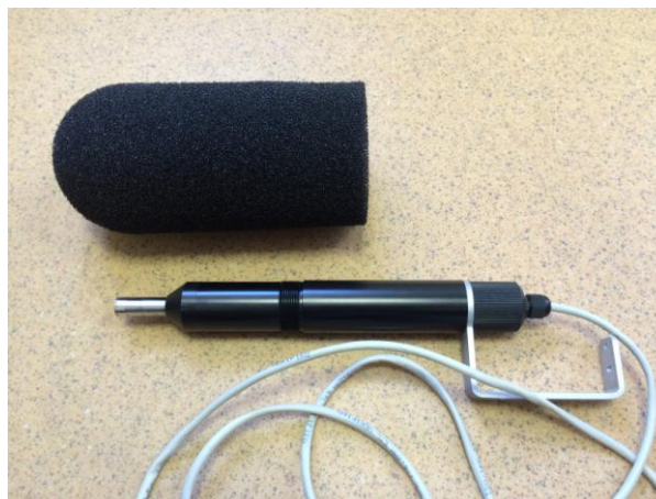
Рис.3е. Заключительный этап сборки: оденьте ветрозащиту на микрофон
