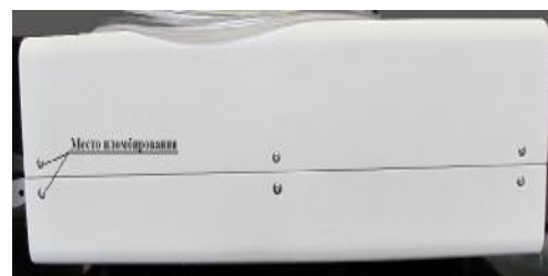
Рисунок 2 - Схема пломбировки счетчиков АССЧ 4705
