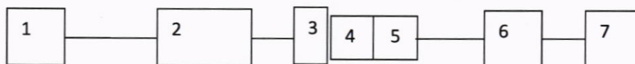
1 – генератор сигналов; 2 – блок питания ЭВ; 3 – ЭВ; 4 – капсюль; 5 – предусилитель микрофонный; 6 – источник питания микрофонный; 7 – вольтметр Рисунок 2
