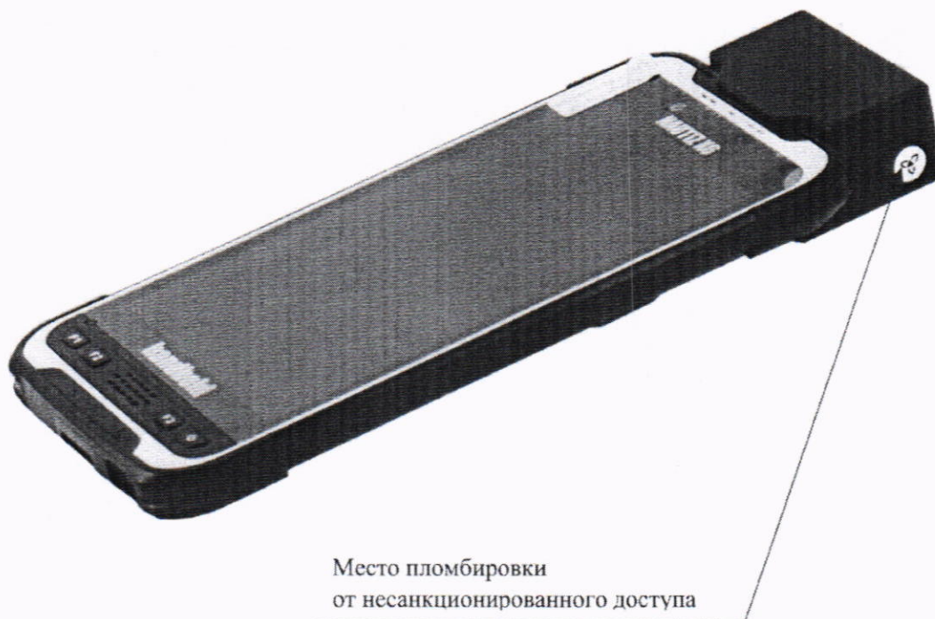
Рисунок 3.1 – Схема пломбировки от несанкционированного доступа БОИ5 из состава спектрометров
