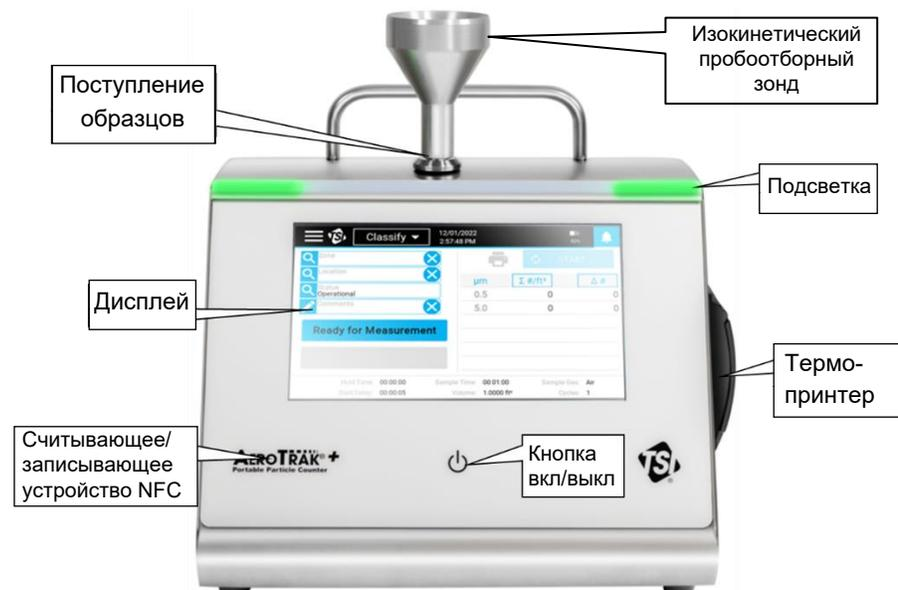
Сенсорный дисплей обеспечивает интуитивно понятный графический интерфейс пользователя (GUI). Светодиодная подсветка показывает, когда прибор включен, и предоставляет информацию о состоянии во время отбора проб. На левой стороне панели, под этикеткой портативного счетчика частиц AeroTrak®+, находится считывающее/записывающее устройство Near-Field Communication (NFC), обеспечивающее бесконтактную связь.
