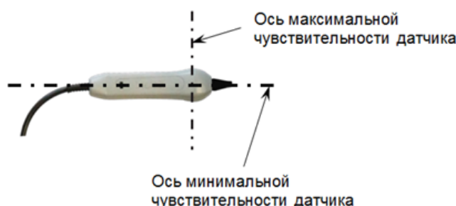
Рисунок А.2 Оси чувствительности датчика MED-127.
