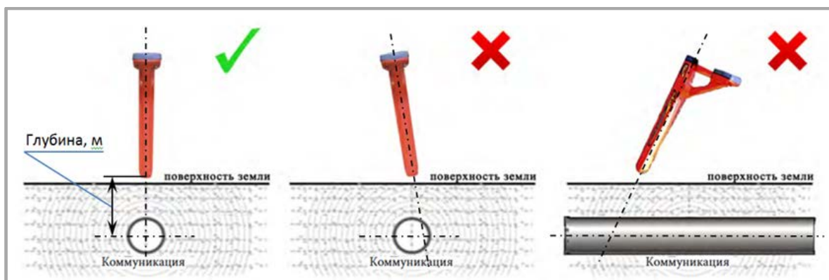
Рисунок 3.6 – Правильное положение приемника при замере глубины
