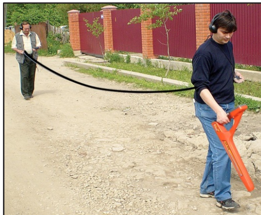
Рисунок 7.3 Обследование при помощи ДОДК-117.
