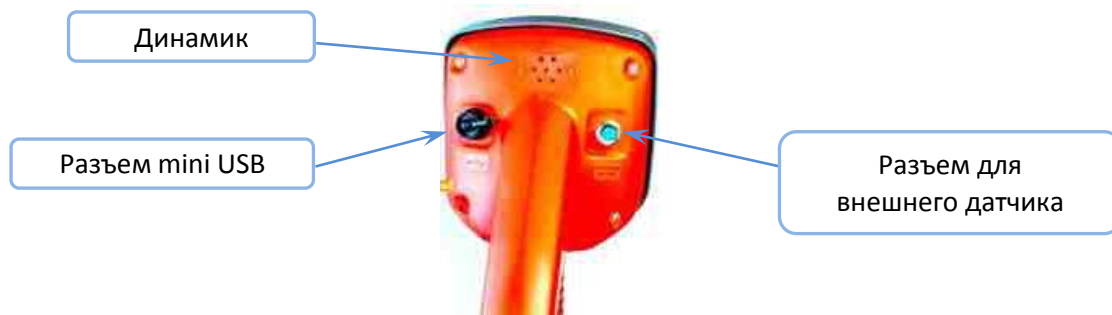
Рисунок 1.2 – Разъемы на приемниках АП-019.4 и АП-019.4L
