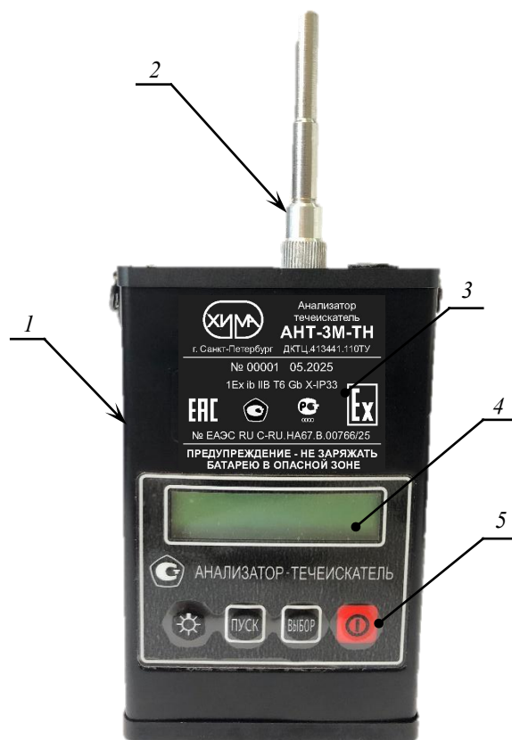
1 – блок прибора; 2 – трубка; 3 – маркировка; 4 – жидкокристаллический индикатор; 5 – клавиатура плёночная.
